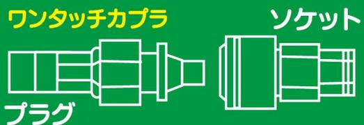
そのまま、プラグに差し込むだけで確実にロックされます。従来品に比べ簡単でスピーディーな作業が可能です。
