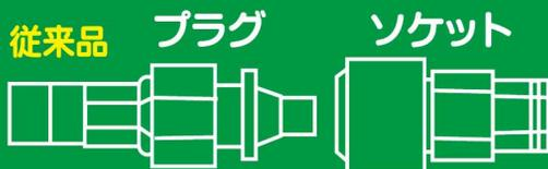
リングを手前にひきながらプラグに差し込み、再度リングを戻す。
