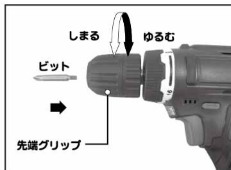
ビットの取り付け
