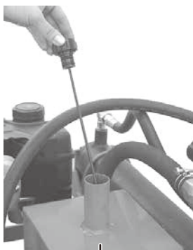
油圧オイルタンク
