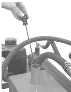
油圧オイルタンク
