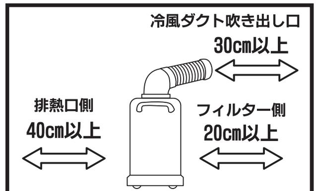
○フィルター・排熱側・冷風ダクトの吹き出し口から20~40cm以上離して設置してください。（上図参照）
