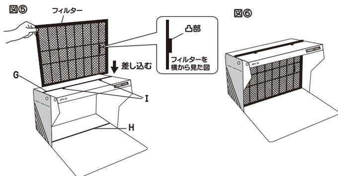
4. 図⑤のようにフィルターをGの溝に入れ、下まで差し込みHの溝へ入れて図⑥のように固定すれば完成です。Gの溝に入れる際にフィルター側の凸部をIの溝のどちらかにあわせないと入らないようになっています。Iの溝にあわせて入れてください。また、溝は貫通してしますので本体を持ち上げないでください。フィルターが下へ抜けてしまいます。
