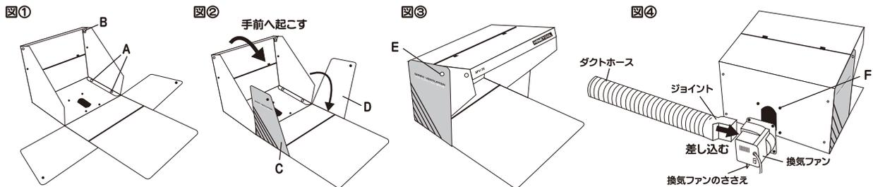
1. 図①のように折り目で折って、AとBの位置のネジを確実にはめて組み立ててください。反対側のネジも同様にはめてください。
